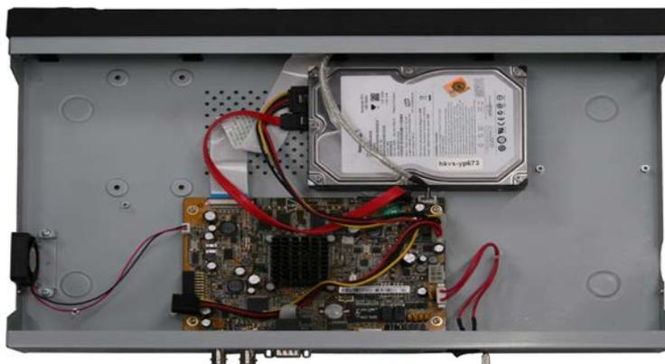
Рис.2.4. Последовательность действий при установке жесткого диска
