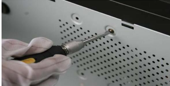
Рис.2.1. Последовательность действий при установке жесткого диска
