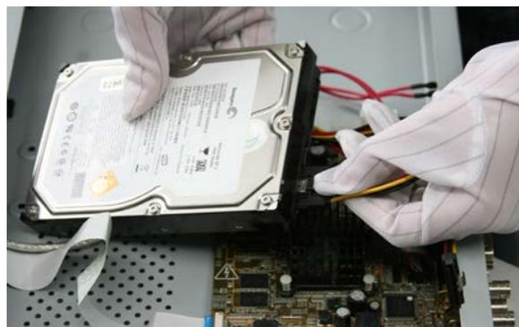
Рис. 2.3. Последовательность действий при установке жесткого диска
